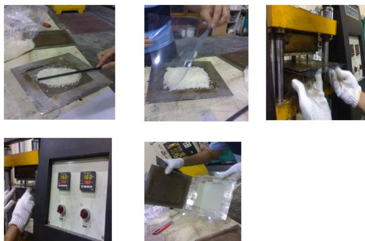
ภาพที่ 11 กระบวนการขึ้นรูป PLA ด้วยกระบวนการกดอัดด้วยความร้อน [36]
