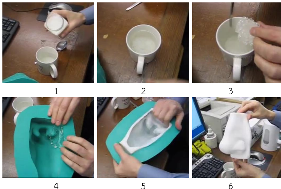
ภาพที่ 6 ขั้นตอนการขึ้นรูปผลิตภัณฑ์ด้วยแม่พิมพ์ [6]
