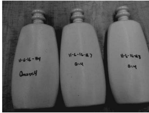
ภาพที่ 3 ขวด P(3HB-4HB) ที่ Rocheleau R4 extrusion blow molding machine [21]
