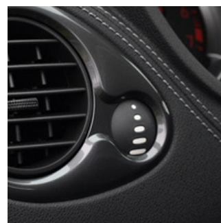
ภาพที่ 8 ตัวอย่างชิ้นงานในอุตสาหกรรมยานยนต์ที่ผลิตจาก Bio-PC [9]
