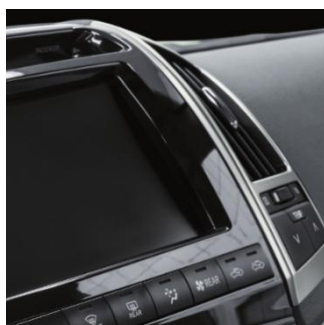
ภาพที่ 8 ตัวอย่างชิ้นงานในอุตสาหกรรมยานยนต์ที่ผลิตจาก Bio-PC [9]
